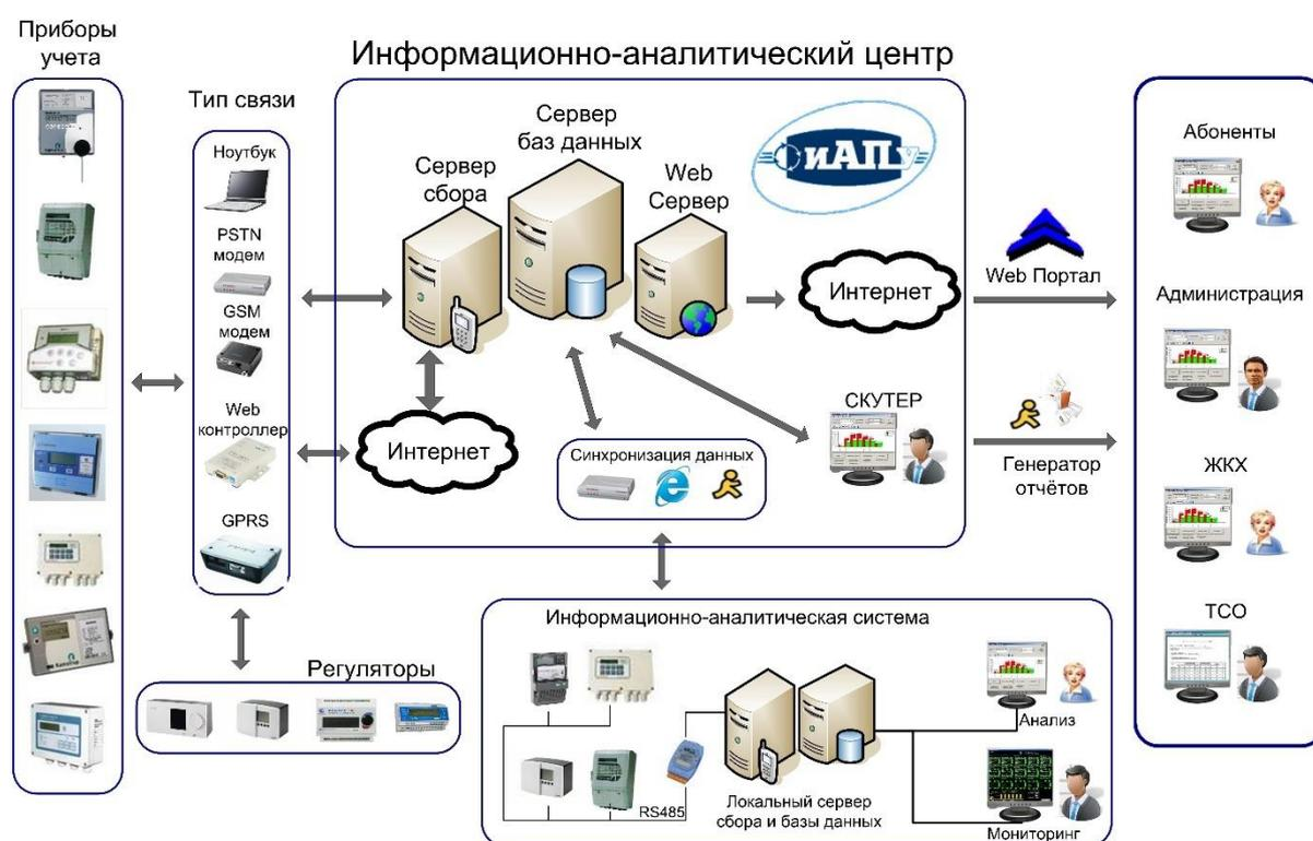
Рис. 1. Архитектура центра сбора данных с приборов учёта и регулирования
