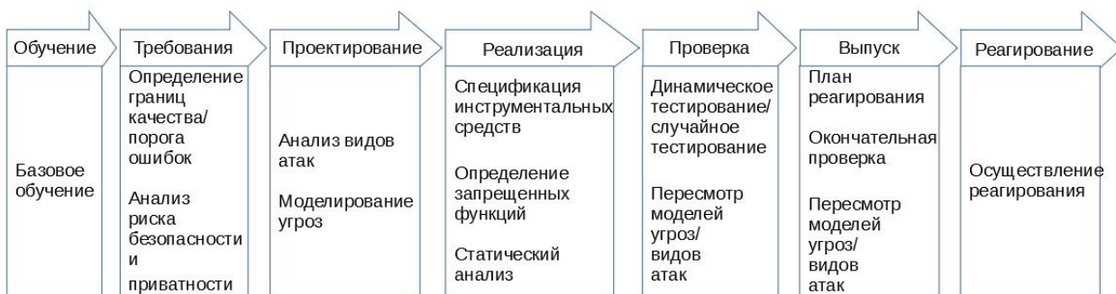
Рис. 4. Жизненный цикл разработки безопасного ПО
