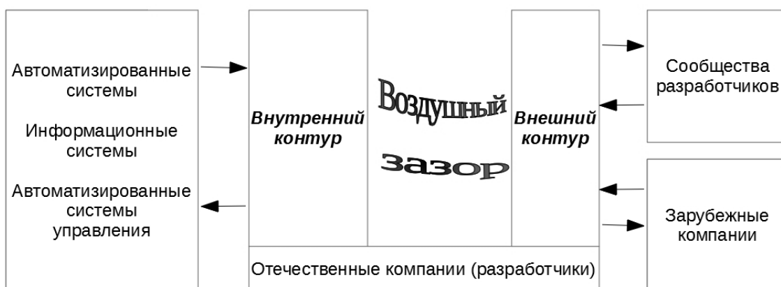
Рис. 5. Реализация метода обеспечения безопасности ПО с применением «воздушного зазора»
