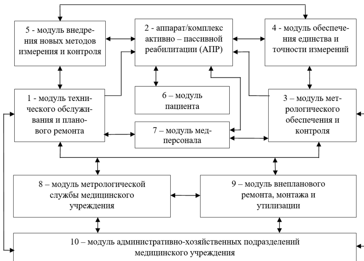
Рисунок 2. Структура взаимодействия технических служб при внедрении метрологического обеспечения аппаратов/комплексов активно – пассивной реабилитации (АПР)
