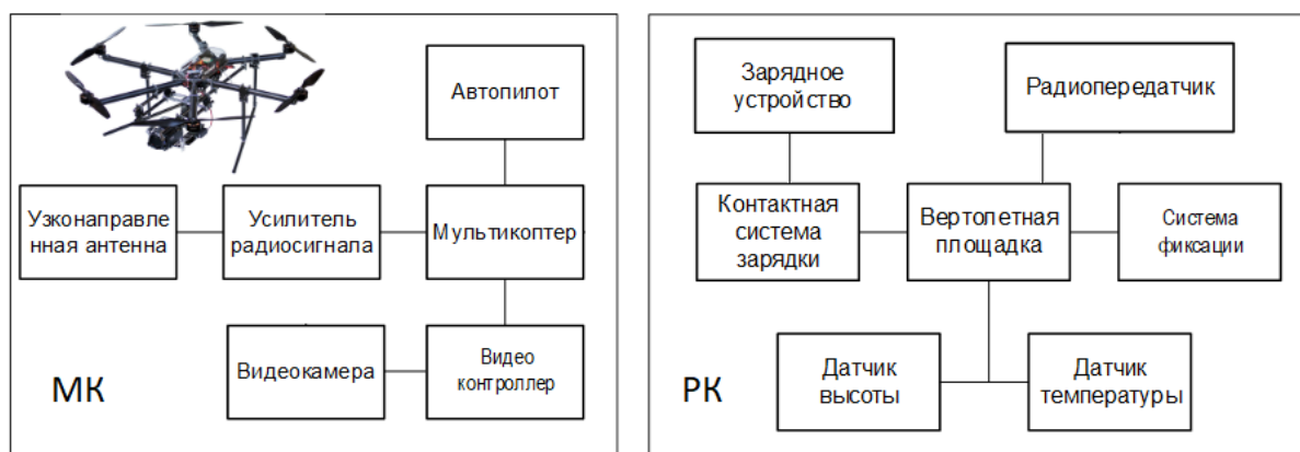
Рис. 1. Структурная схема мультикоптера (слева) и роботизированного контейнера (справа)
