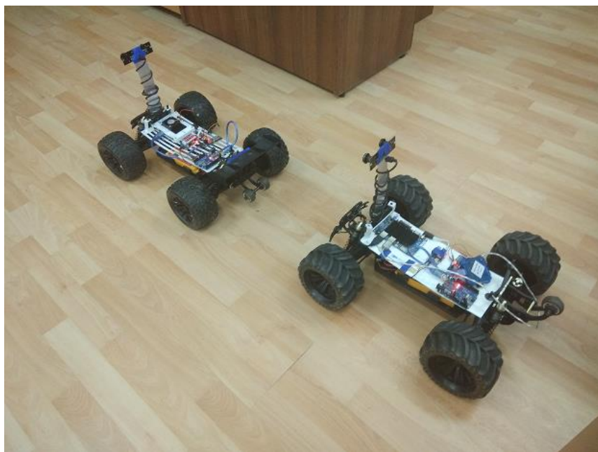
Рис. 4. Фрагмент натурного моделирования задачи визуального слежения
