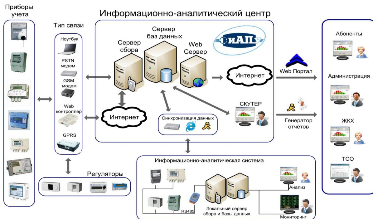
Рис. 1. Архитектура центра сбора данных с приборов учёта и регулирования
