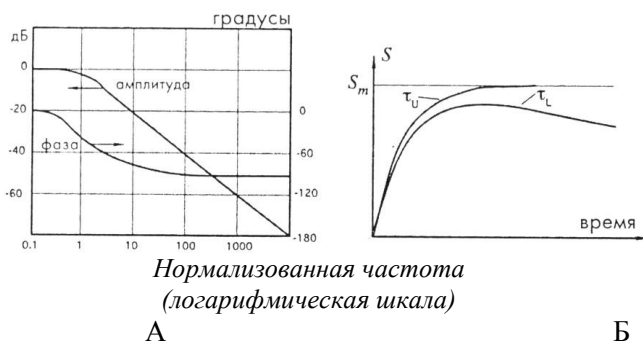
Рис.1. Частотные характеристики: А – частотная характеристика датчика первого порядка, Б – частотная характеристика датчика с ограничениями по верхней частоте среза, где \tau_U и \tau_L - соответствующие постоянные времени
