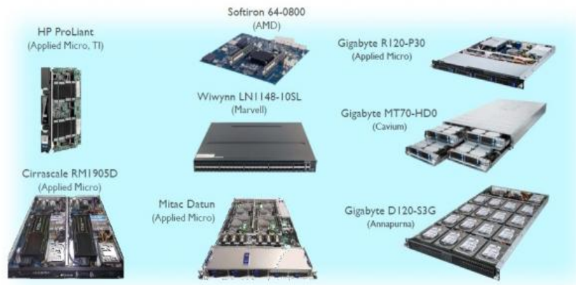
Рис. 4 Платы на основе ARM-процессоров
